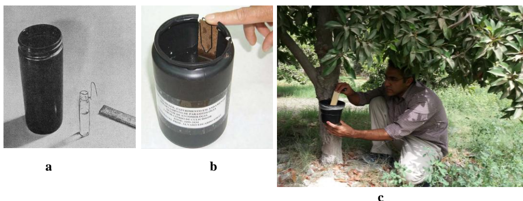
شکل ۱. a,b. CDC Ovitrap (۱۷) و متعلقات آن، c: کارگذاری آن در مناطق جنوب شرق ایران
