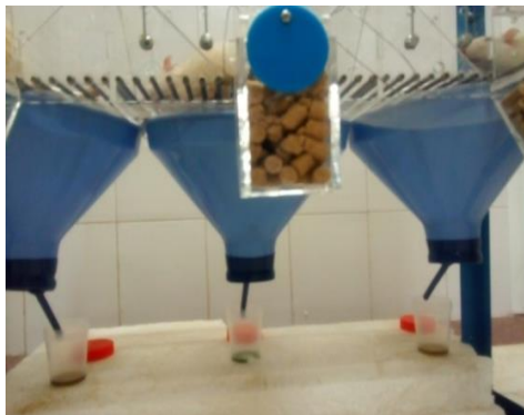
شکل ۱ - نحوه جمع آوری نمونه ادرار ۲۴ ساعته با قفس متابولیک
